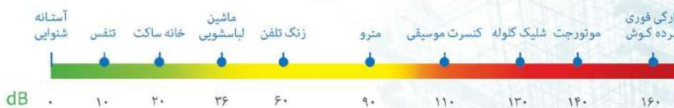
عملکرد صوتی سیستم فاضلابی پروتکت، شامل لوله، اتصالات و بست پایدار، توسط موسسه معترض فرانهوفر آلمان مورد آزمایش قرار گرفته است و نتایج آن نشان‌دهنده کاهش چشمگیر میزان انتقال صدا تا سطح ۱۹ دسی‌بل می‌باشد.
